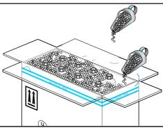
2. PLACE PLASTIC BAG INSIDE BOX, SEAL AND INSERT INNER PACKAGINGS SURROUNDED BY A MINIMUM OF 50MM VERMICULITE IN ALL DIRECTIONS.
